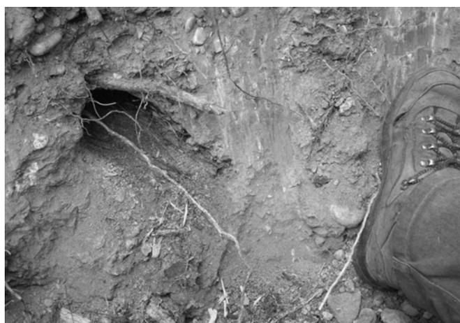
Figure 4 : Galerie liée à la décomposition d'une racine dans des matériaux à matrice limoneuse cohésive
